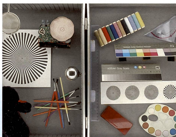
Anhand solcher Testmotive kann die Bildqualität bewertet werden. Entscheidend für ein gutes Resultat ist nebst der Kamera vor allem auch das Objektiv (Quelle: gfv.de)
