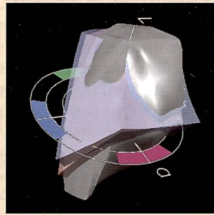
Die Farbraumdarstellung in ProfileMaker zeigt, dass die profilierte Digitalkamera (grau) deutlich mehr Farben erfasst, als sich in den Arbeitsfarbräumen Adobe RGB (rot) und sRGB v2 (blau) beschreiben lassen.
