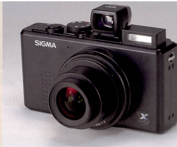
En habit du dimanche: avec viseur à cadre inséré et flash intégré sorti. Le Sigma DP1 séduit par son style simple et classique. Le capteur Foveon est le même que celui qui équipe le DSLR Sigma SD14. Ses dimensions (21 x 14 mm) sont surprenantes.
