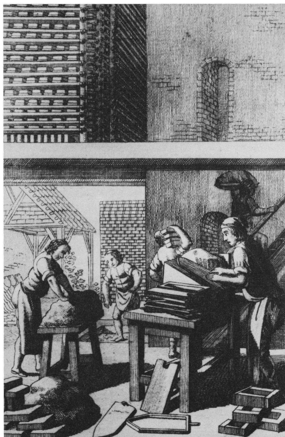
Abb. 5 Der Arbeitsablauf des Handziegels in einer synoptischen Darstellung. Der Ziegelbrenner , Stich von G. Vogel nach A. Gabler. Slg. Ziegelei- Museum (ZM Reg.- Nr. 1104)
