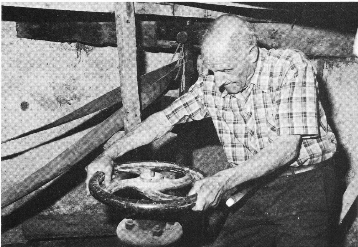
Abb. 1 Fritz Gisler beim Öffnen des Turbinen-Schiebers in der Beimühle. Die Turbine treibt die Steinmühle an. (vgl. weiter unten im Text).
