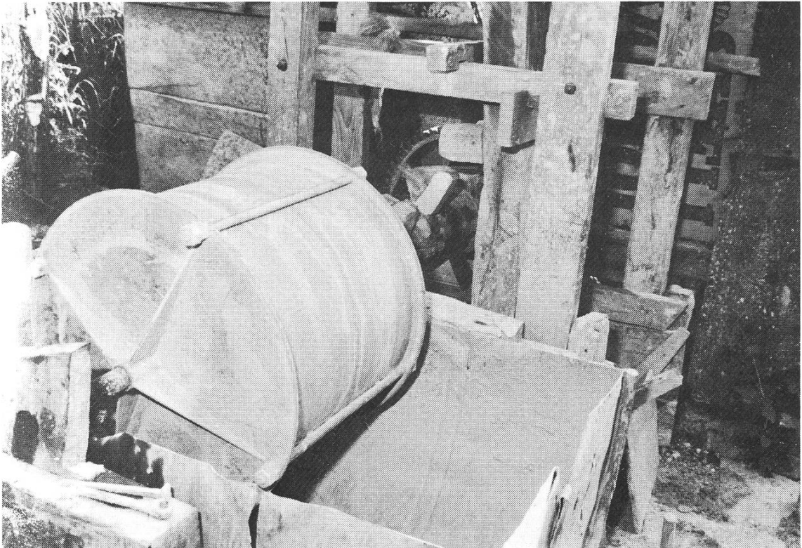
Abb. 12 Die Mischtrommel zum Mischen verschiedener Lehmqualitäten.
