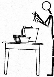
Arbeitsgeräte stehen zu hoch Armhaltung ermüdet
