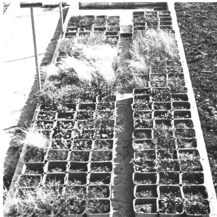
Abb. 11 Versuchsanlage Strelberg oberhalb Davos (2355 m). 156 Blumentöpfe. Links im Hintergrund das Schiahorn
