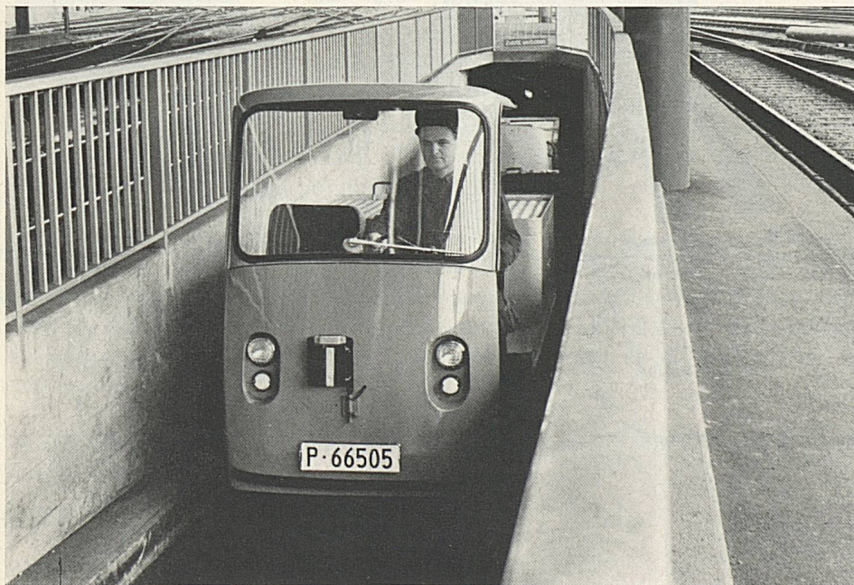
Einer der neuen Vierrad-Elektroschlepper für die Gepäckbeförderung. Das Fahrzeug vermag auf den Rampen der Gepäcktünnel eine Anhängelast von 4 t mit einer Geschwindigkeit von 4 km/Std. zu schleppen und weist eine Höchstgeschwindigkeit von 18 km/Std. auf.
