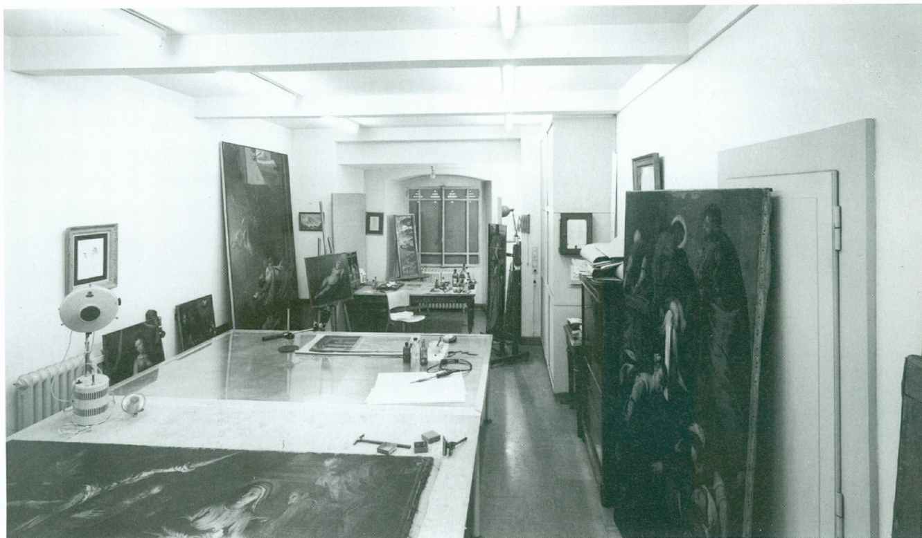
1. Vue de l'atelier de restauration de peinture en 1964. Au premier plan, la table chauffante, appareil très en vogue à cette époque pour le rentoilage des peintures
