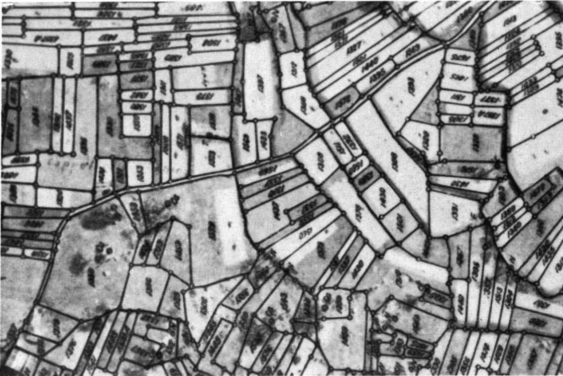
Fig. 5. Identifizierungskrokis aus dem Operat „Media Blenio“; Original im Bildmaßstab ca. 1 : 1200. Man beachte die signalisierten Grenzpunkte
