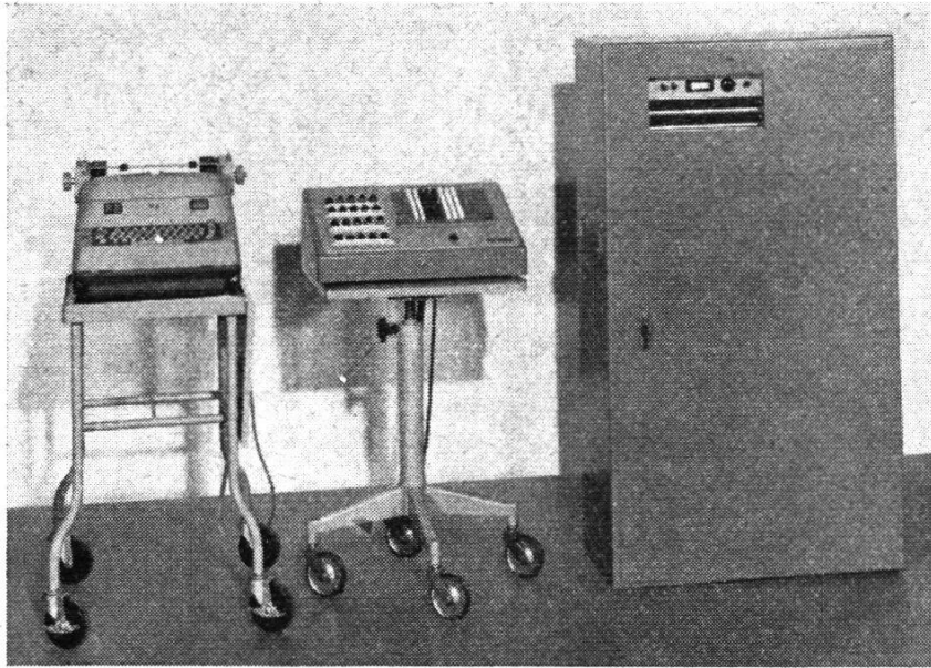
Abb. 2. Elektrisches Koordinatenregistriergerät EK3 für die Registrierung von Autographenkoordinaten und Querprofildaten in Klarschrift und auf Lochstreifen, Lochkarten oder Magnetband
