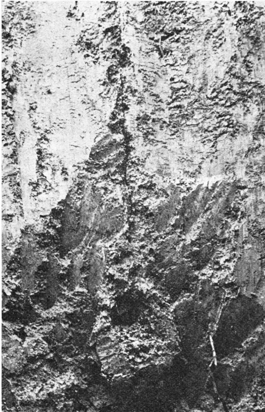
Bild 8. Molegang und Schwertrieb nach 6 Jahren
