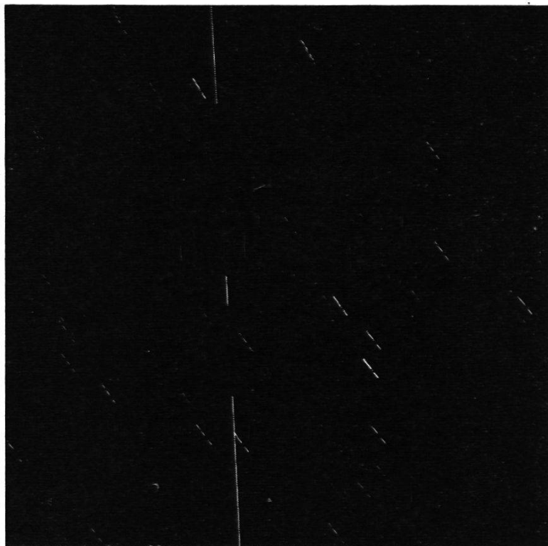
Fig. 3. Mit Wild BC-4-Kamera aufgenommene Spur des amerikanischen Ballonsatelliten «Echo» I. Die Hintergrundsterne auf diesem zentralen Ausschnitt der Platte (etwa 13 \times 13^\circ ) gehören zum Sternbild Herkules. Aus den unsymmetrischen Unterbrechungen ist ersichtlich, daß sich der Satellit etwa 100mal schneller und in umgekehrter Richtung als die Sterne bewegt hat
