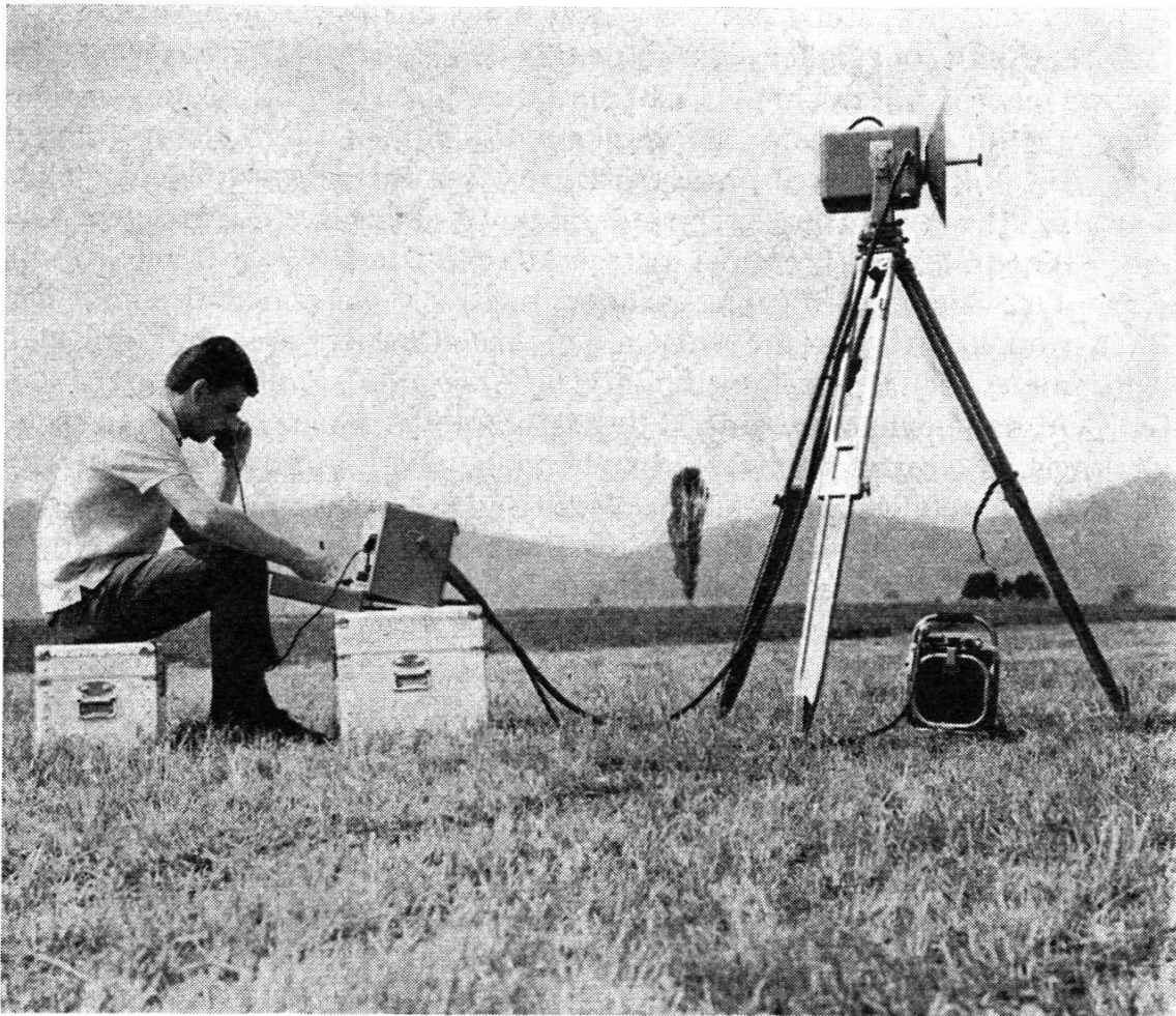
«Distomat DI 50» der Firma Wild-Heerbrugg: Elektronisches Distanzmeßgerät für Meßbereiche von 100 m bis 50 km, mit dem über die Laufzeit und damit über den Laufweg elektromagnetischer Wellen Distanzen gemessen werden
