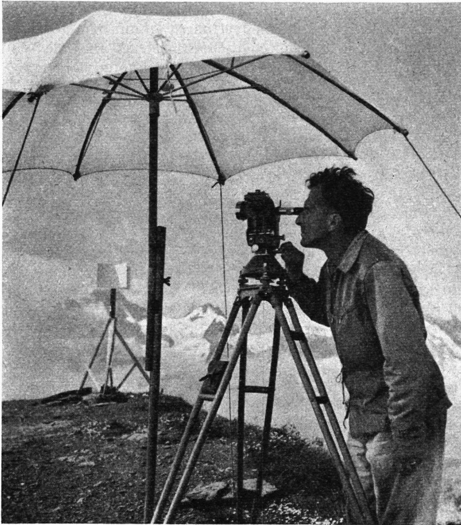
Präzisionstheodolit Wild T3 für Triangulationen höherer Ordnung
