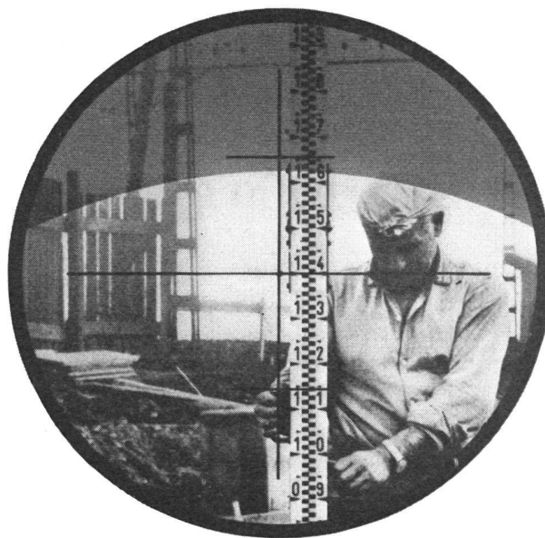
Abb. 2 Bei ungenügender Grobhorizontierung erscheint im Fernrohrgesichtsfeld die Warnblende
