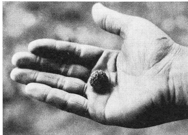
Abb. 3 Eine Schwammgummikugel, wie sie für Milchleitungen vom Kaliber 11 mm verwendet wird
