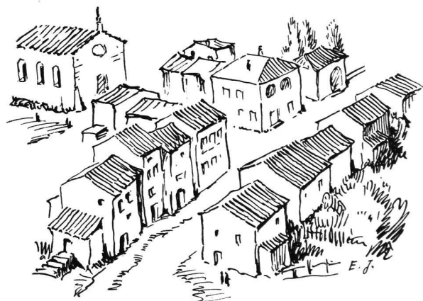
Figur 1 aus dem Kommentar zur Tafel 39 von Eduard Imhof: Flachgeneigte Dächer mit Traufzuge in den französischen und italienischen Landesteilen
