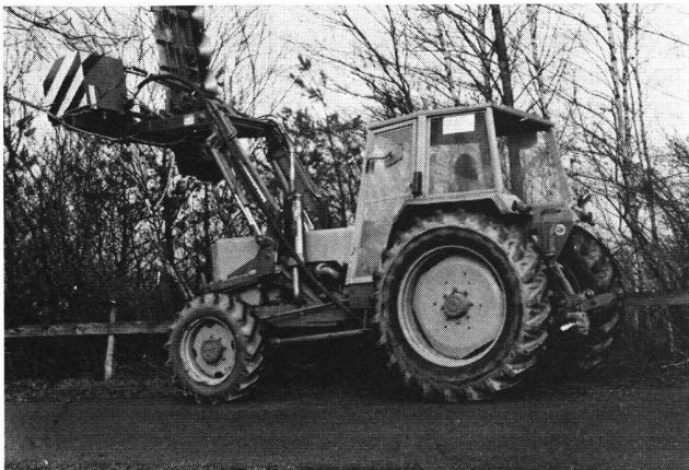
Abb. 1 Der Traktor mit dem aufgebauten Heckenschneider
