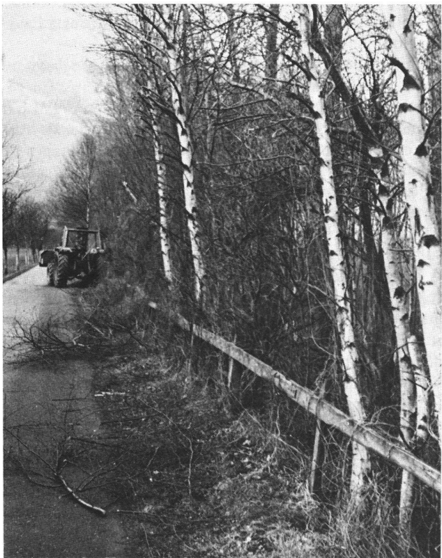
Abb. 3 Zäune sind kein Hindernis für den Einsatz der Maschine. Man beachte den sauberen Schnitt der Fräsblätter.
