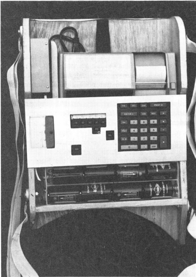
Abb. 1 Taschencomputer HP-97 in feldauglichem Kasten, gegen Nässe und mechanische Einflüsse geschützt
