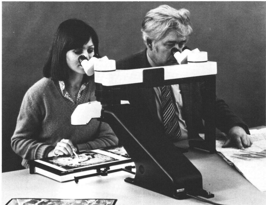
Wild APT 1: Interdisziplinär – dieses Schlagwort hat besonders bei der Interpretation komplexer Zusammenhänge seine Bedeutung. Zwei Beobachter sehen mit Wild APT 1 das gleiche räumliche Modell.
