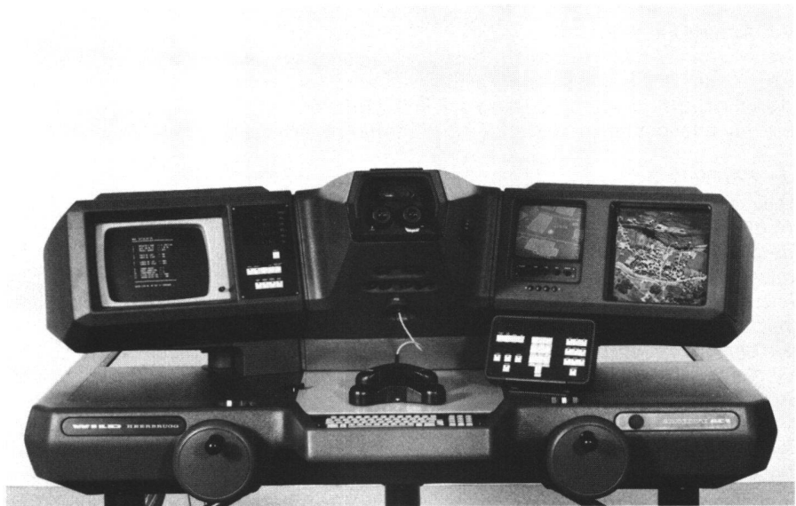
Abb. 5 Betrachtungseinheit des Aviolyt AC 1 mit Freihandführung, Tastatur für das rechnerunterstützte Zeichnen und Fernsehbild der Kartierung am Zeichentisch.
