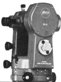
Kern K 1-S. Ingenieurtheodolit mit Skalenablesung
