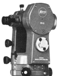
Kern K 1-S. Ingenieurtheodolit mit Skalenablesung
