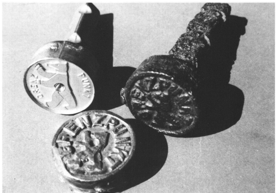
Abb. 2 Alter und neuer Grenzbolzen.
