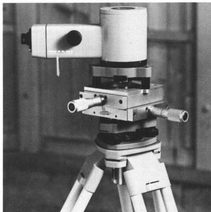
GMT5/ZL: Zwei Messstische können zu einem Kreuztisch kombiniert werden. Hier vereinfachen sie in einem Schacht die Deformationsmessung mit dem automatischen Zenitlot Wild ZL. Kleinste Verschiebungen in zwei zueinander senkrechten Achsen lassen sich so exakt bestimmen.
