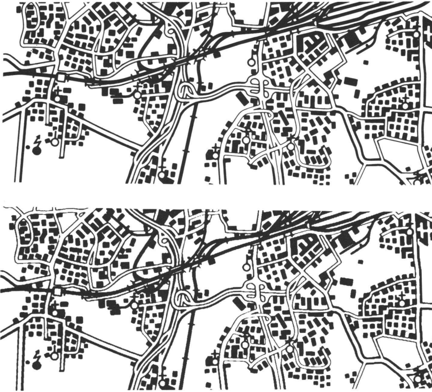
Abb. 4 Eine kartographische Originalfolie (oben) und ihre Reproduktion mit dem Scanner (unten) in einer Auflösung von 32 Punkten/mm (ca. doppelt vergrößert).
