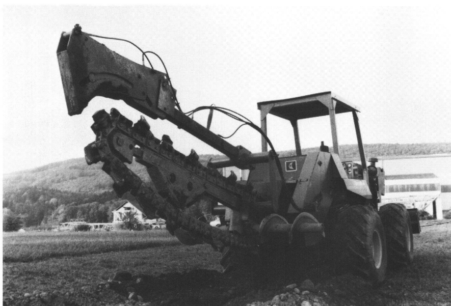
Abb. 5 Grabenfräse Ditch-Witch mit 66 PS, einer Arbeitstiefe bis 210 cm und Grabenbreiten von 16, 25, 32, 40 und 60 cm.
