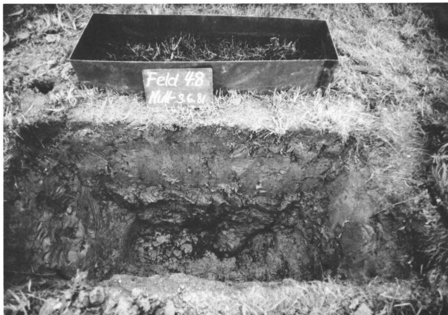
Abb. 1 Die Versuchsanordnung: Im Vordergrund die Profilgrube mit dem dunkelgefärbten Infiltrationswasser auf der Grubensohle. Dahinter der Blechrahmen, der die Infiltrationsfläche abgrenzt.
