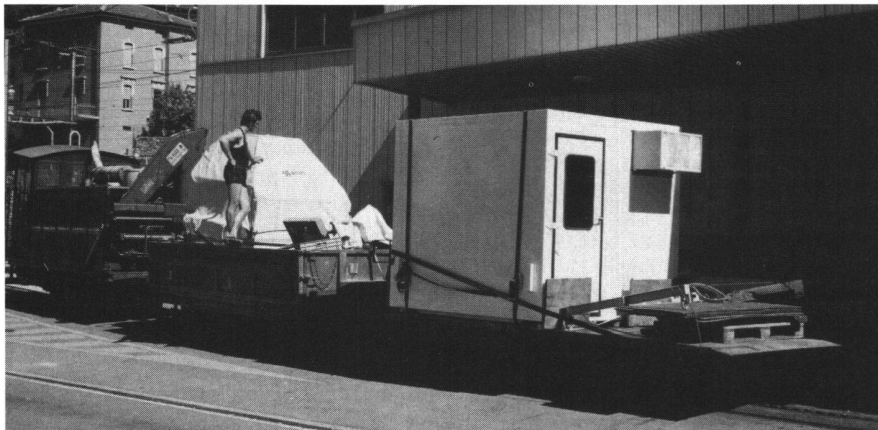
Abb. 4: Zugskomposition mit der gesamten Ausrüstung zum Transport bereitstehend. Vor der Diesel-Lokomotive ist das Teleskop sichtbar, das auf einem luftgefederten Transportrahmen steht, der mit einer Neigung in Längsachse konstruiert wurde, um die Steigung der Strecke von 22% auszugleichen. In der Kabine sind das elektronische Steuersystem inkl. Computer sowie die Klimageräte untergebracht.
