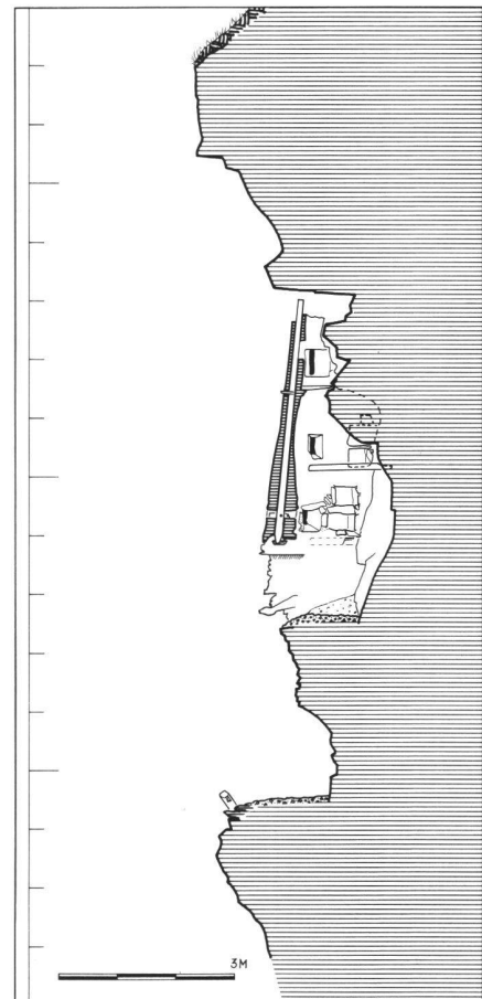
Abb. 5: Hérémente VS, «Grotte aux Fées», Beispiel eines Vertikalschnittes durch den oberen Bau von Abb. 2; mit Holz armierte, gegen den Berg geneigte Mauer; 4 sehr niedrige Abschnitte (Geschosse?), darin Lichtscharten und Wandfächer; unten Zugangsband zum unteren Bau mit Auflager eines ehemaligen Steigbaumes zum Eingang in den oberen Bau.
