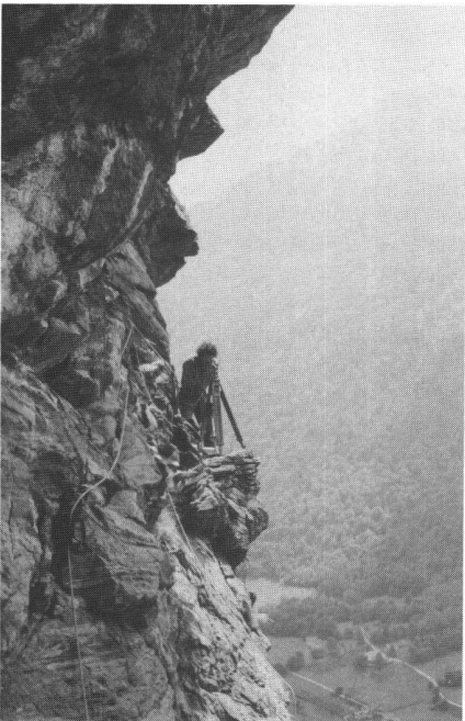
Abb. 4: Polaraufnahme mit Theodolit in steiler Wand; Sicherung mittels Seilgeländer.
