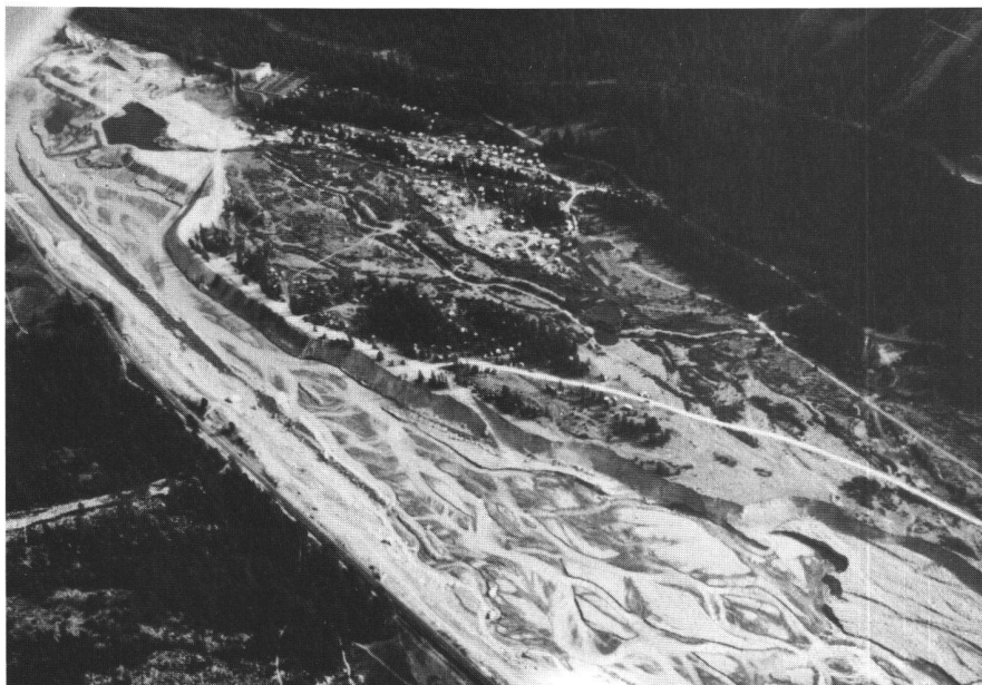
Abb. 4: Kiesabbaugebiet Ova da Bernina. Durch Förderung der im nur leicht gestörten Teil bereits sichtbaren Muster von Flussverzweigungen soll die Regeneration eines natürlichen Flussraums erreicht werden (Foto: O. Lang, Uster).
