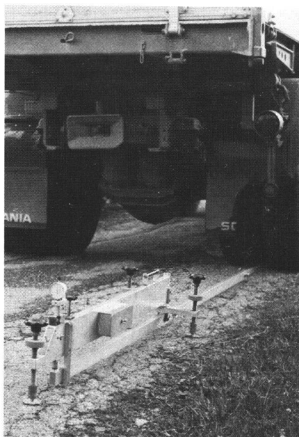
Abb. 5: Deflektionsmessung mit dem Benkelman-Balken. Dabei wird die elastische Einsenkung (elastische Deflektion) der Strassenoberfläche unter der ruhenden Belastung des Zwillingrades eines Lastwagens gemessen (Foto: Ch. Boss).
