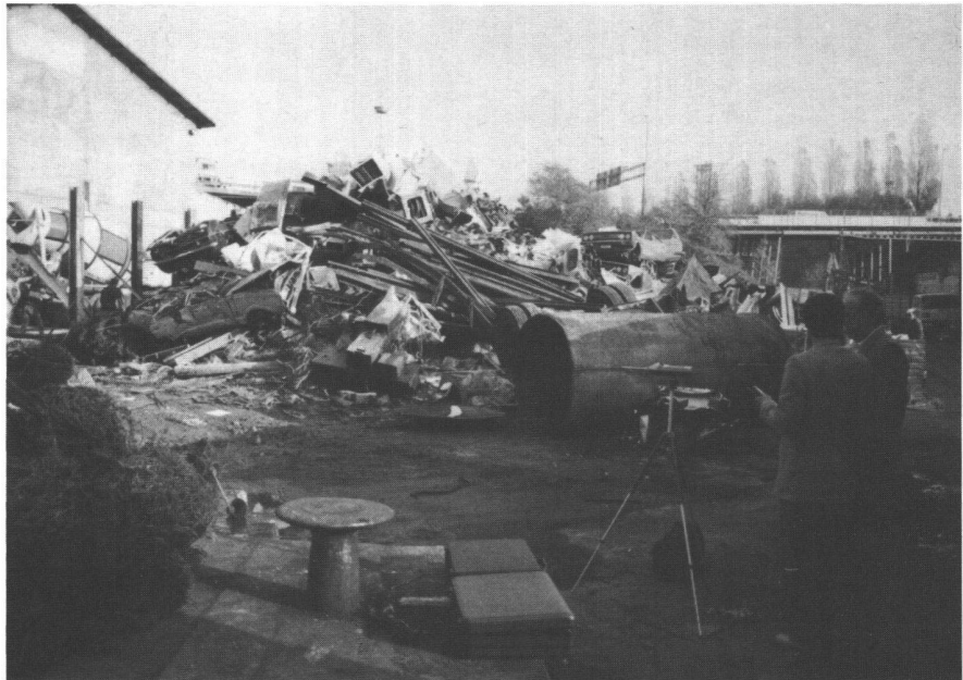
Fig. 5: Mesure des niveaux sonores chez un récupérateur de métaux.
