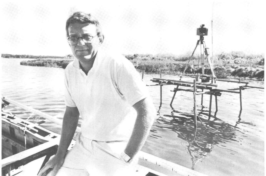
Abb. 2: Im Finja-See bei Hässleholm ist seit ein paar Jahren Schwedens grösste Seerestaurierung im Gange, die auch eine genaue Kartierung des Seebodens umfasst. Um kontinuierlich die genaue Position des Vermessungsschiffes bestimmen zu können, verwendet man seit Frühjahr ein Geodimeter 140T, das auf einer Plattform mitten im See aufgestellt ist.
