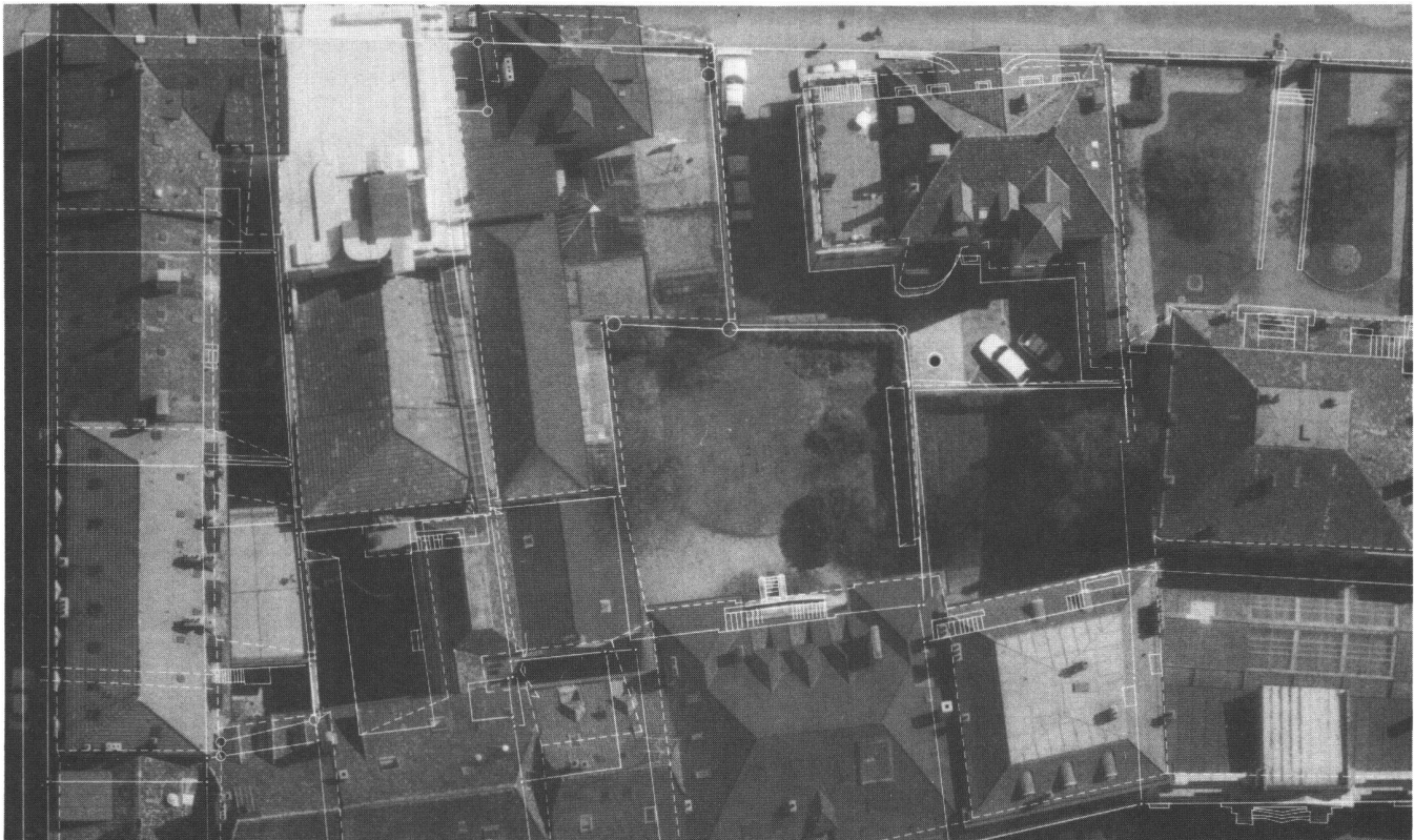
Fig. 4: Superposition d'une photographie aérienne avec un plan cadastral adapté à la géométrie de la photo. Les bâtiments sont reportés au niveau du sol (ligne continue) et au niveau des toitures (lignes traitillées). On constate ainsi qu'un grand nombre d'éléments figurant sur des photographies aériennes permettent de contrôler les erreurs géométriques d'un plan cadastral. (Document reproduit avec l'autorisation de la Direction fédérale des mensurations cadastrales.)
