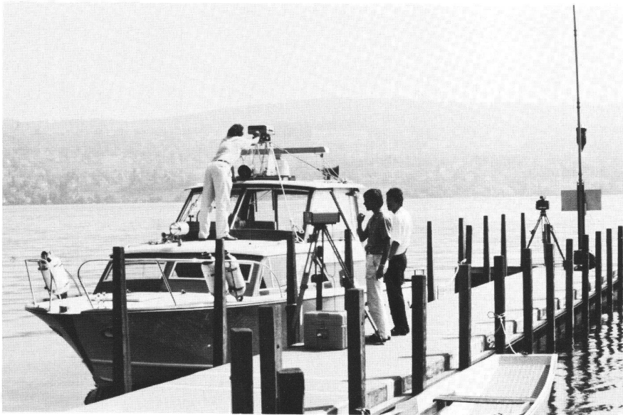
Abb. 7: Differentielles GPS. Für Testzwecke wird auf einem Schiff der Zürcher See-polizei ein GPS-Empfänger montiert. Direkt unter dem Empfänger befindet sich der Reflektorkranz für die optische Verfolgung. Am Molenkopf ist der automatische Theodolit mit Laser-Distanzmesser erkennbar. Die fixe GPS-Referenzstation ist neben dem Schiff mit einem Stativ auf der Mole installiert. (Aus: Cocard, Geiger, 1990 / IGP-ETHZ.)
