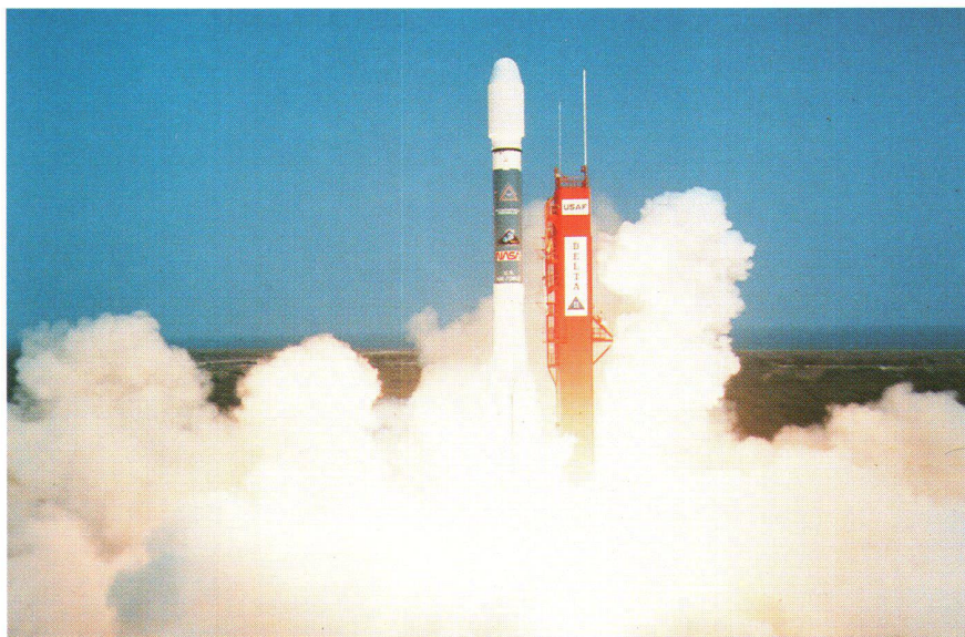
Abb. 2: Mit Trägerraketen des Typs Delta II werden die Navstar-Satelliten auf ihre kreisförmigen Erdumlaufbahnen transportiert. (Bild: NASA / Archiv Schmidt.)
