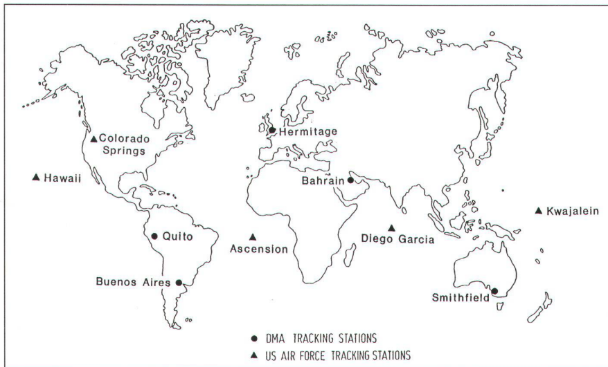
Abb. 4: Kontrollsegment des GPS. Die Luftwaffe der USA betreibt das eigentliche, operationelle Kontrollnetz. Die 5 Stationen sind um den ganzen Erdball verteilt. Die Defense Mapping Agency (DMA) der USA unterhält zusätzlich 5 Stationen. (Aus: Müller, A., Mil. Geo., BRD.)
