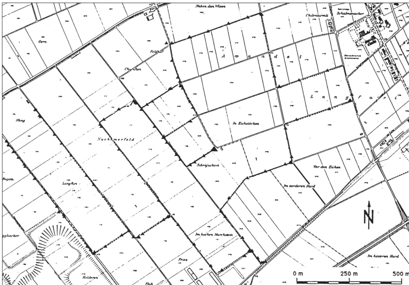
Abb. 8: Kartierung mit GPS. Im Rafzerfeld wurden kinematische Vergleichsmessungen zwischen GPS und automatischem Zielverfolgungstheodoliten durchgeführt. Die Dreiecke bezeichnen die GPS-Position (hier nur alle 15 sec). Die Punkte zeigen die durch den Laser Tracker gewonnenen Koordinaten. (Aus: Cocard, Geiger, 1990 / IGP-ETHZ.)
