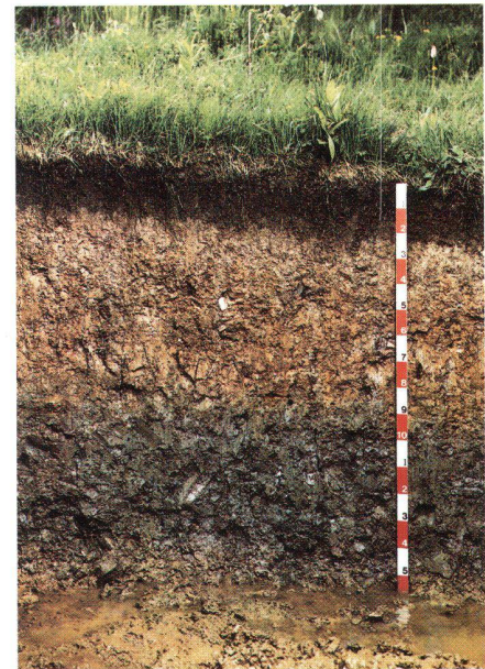
Abb. 2: Vernässter Boden vom Typ eines Fahlgleys (aus Richard et al., 1978).
