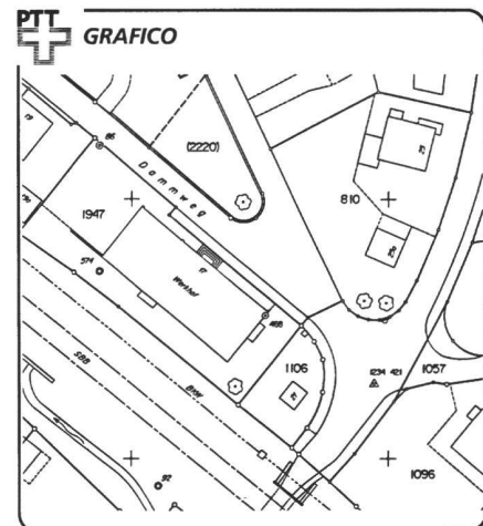
Abb. 4: Grundbuchplan als Basis für Werkleitungsplan PTT.
