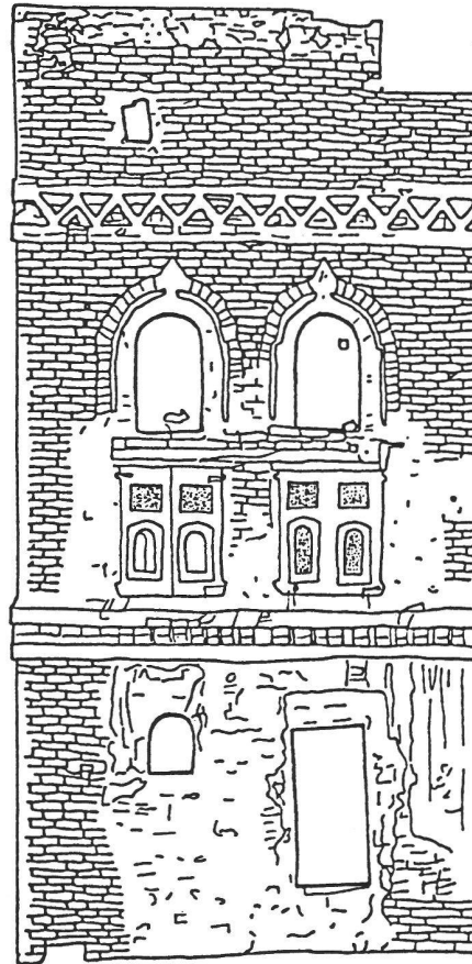
Abb. 5: Entzerrung (links) und steingerechte Handzeichnung (rechts).
