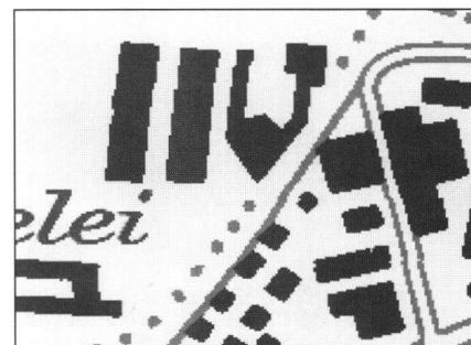
Abb. 5: Pixelkarte mit erkannten flächenförmigen Objekten (dunkel).
