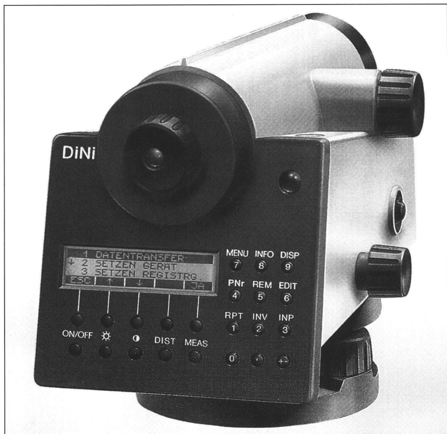
Abb. 3: Das digitale Nivellier DiNi 10 von Zeiss.
