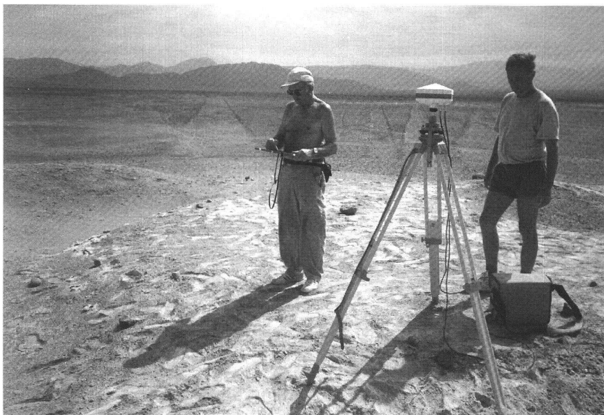
Azimuth-Bestimmungen im Liniensystem «Estrella de Soisongo» mit dem Wild GPS-System 200.
