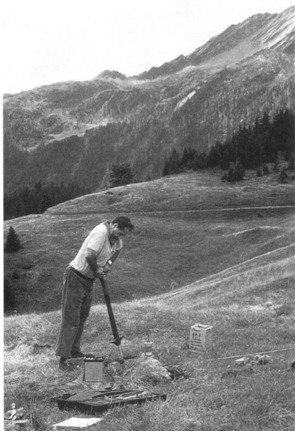
Abb. 7: Einsatz des dynamischen Stabilitätsmessgerätes (nach Pavoni).
