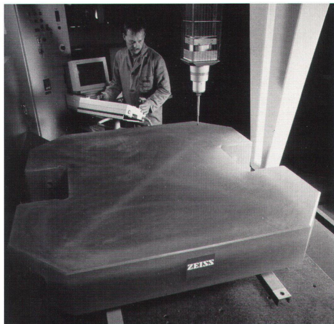
Vermessung des ZERODUR-Blocks für den 1x1 m grossen Prototypen eines Ringlaserkreisels bei Carl Zeiss in Oberkochen.
