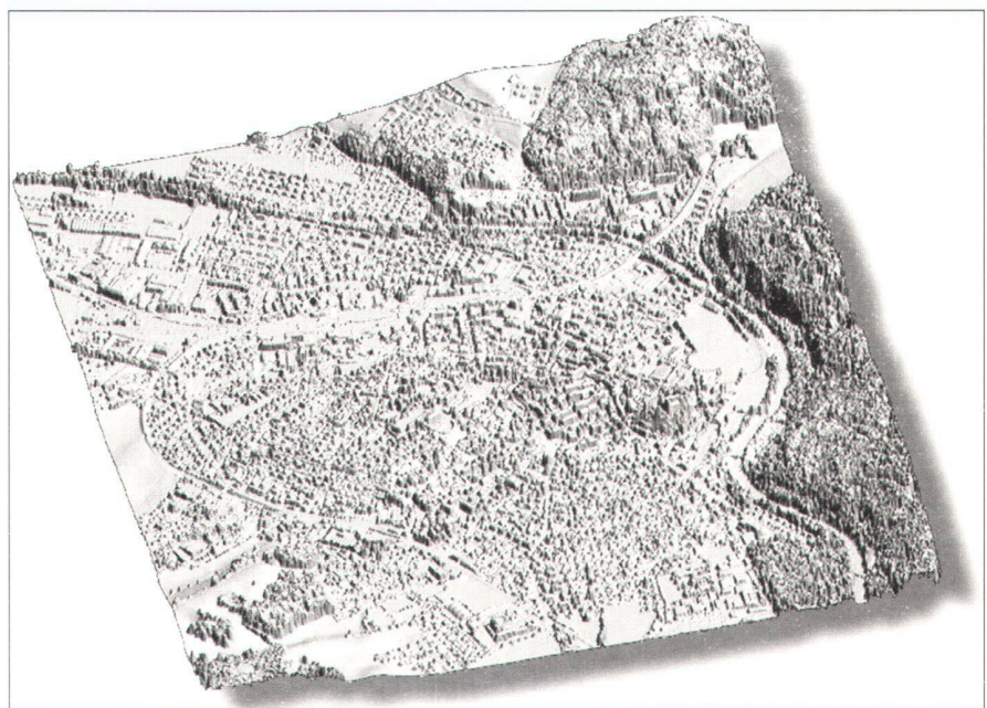
Abb. 4: Datenbeschaffung: Laserscanning als ein Beispiel der Datenbeschaffung. Eine moderne, schnelle und sehr detaillierte Methode zur preisgünstigen 3D-Modellierung grösserer Gebiete. Höhenbestimmung mit oder ohne Vegetationsdecke (z.B. Wald) (© Grunder Ingenieure AG).
