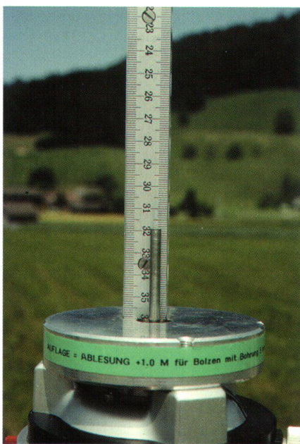
Abb. 4: System zur Bestimmung der Antennenhöhe (L+T).
