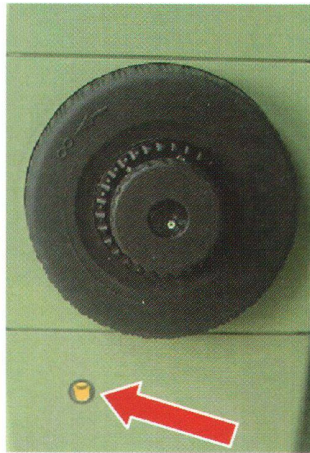
Abb. 3: Neben dem Okular befindet sich eine gelbe Kontrollleuchte. Beim Auslösen einer reflektorlosen Distanzmessung leuchtet die Kontrollleuchte so lange, bis die Messung beendet ist.
