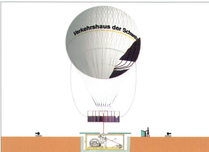
Abb. 3: Der Hiflyer im Verkehrshaus. Das Helium in der Hiflyer-Hülle ist unbrennbar. Es sorgt für einen Auftrieb von fünf Tonnen. Nach Abzug des Gewichts von Hülle, Gondel, Kabel und Passagieren bleibt ein Auftrieb von einer Tonne, der den Ballon steigen lässt. Von der Winde unter der Plattform wird der Hiflyer wieder zurückgeholt. Die kleinen Winden dienen zum Verankern des Ballons über Nacht und bei Wind von mehr als 40 km/h.
